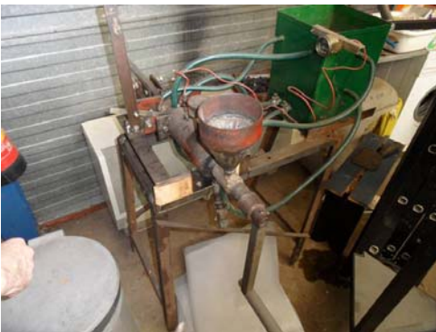
Abbildung 3, Herstellen der Kunststoff Mitnehmer für die Rope-Pump
