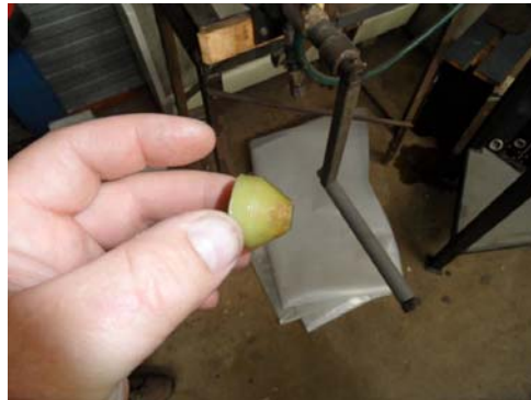
Abbildung 3, Herstellen der Kunststoff Mitnehmer für die Rope-Pump
