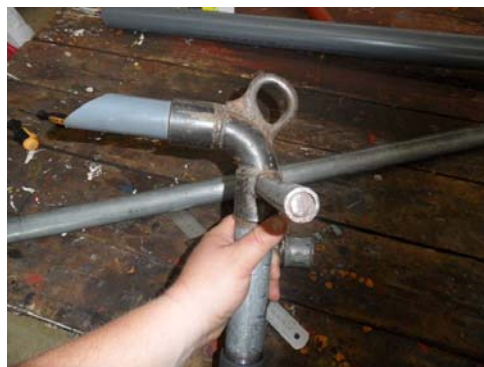
Abbildung 3, Herstellen der Kunststoff Mitnehmer für die Rope-Pump
